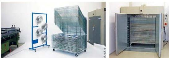
L'asciugatura può essere ulteriormente ottimizzata attraverso l'utilizzo di forni a convezione. Questi sistemi chiusi rendono possibile effettuare l'essiccazione delle pellicole a temperatura costante, con un tasso ridotto di polvere e umidità, senza esporre l'operatore ai vapori dei solventi.
