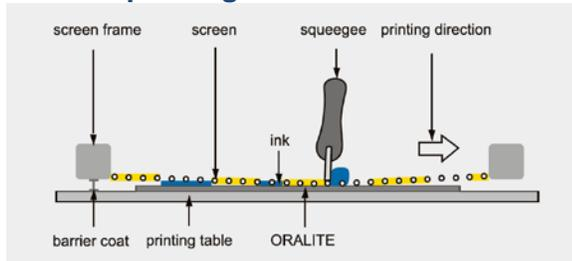
Prima di iniziare il processo di stampa serigrafica, pulire telaio, racla e raschietto con un solvente adatto. Inoltre, ogni pellicola sottoposta a stampa deve essere prima pulita con un panno anti-polvere o anti-statico.
